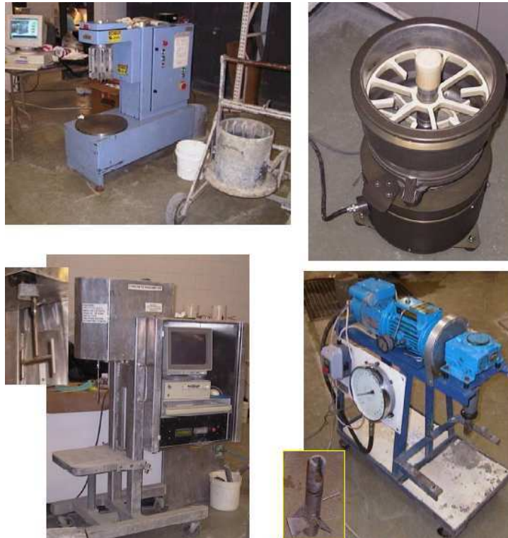
Figure I. 21: rhéomètres à béton: (sens indirect, de haut en bas), le BML, le BTRheom, le two point test, IBB, [KOE, 07]
