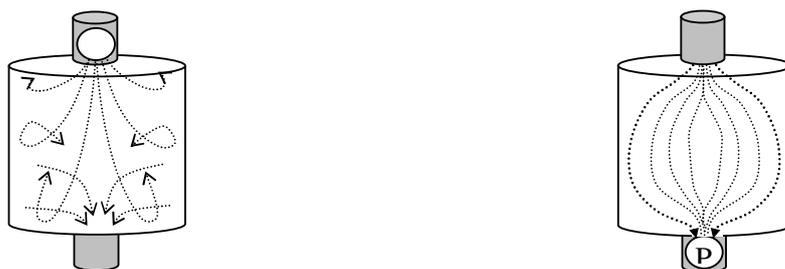
Figure II-8 : Position du générateur de flux soufflant (à gauche), aspirant (à droite)
