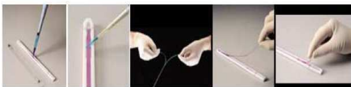
Figure 35 : Etapes d'application d'un strip pour l'isoélectrofocalisation dans un sarcophage en céramique.
