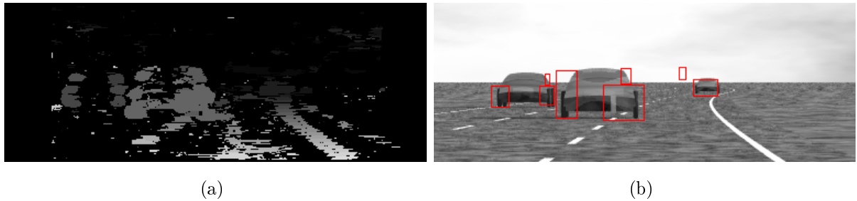
FIG. 4.23 : (a) Carte des disparités obtenues avec notre méthode 1D avec T_{dec} = 0.7 et une hauteur de fenêtre de 5 pixels, (b) Boîtes englobantes obtenues sur la carte des disparités (a) (ici, la caméra droite est orientée vers l'extérieur d'un angle de 0.5 degré).
