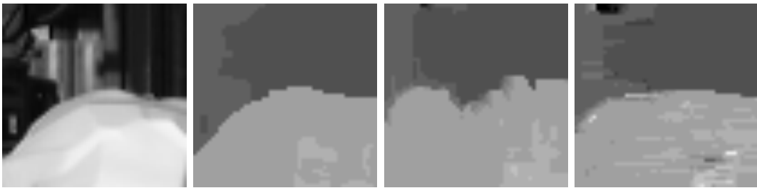
FIG. 2.14 : Comparaison qualitative de résultats de disparité obtenus pour la sous-image (B) par la mesure SSD (Sous-image (B) - Vérité-terrain associée - Disparités obtenues avec une fenêtre carrée 11 \times 11 - Disparités obtenues avec une fenêtre ligne 11 \times 1 ).
