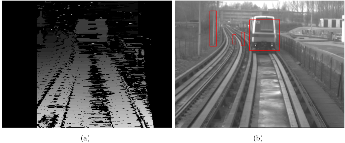
FIG. 4.25 : (a) Carte des disparités obtenues avec notre méthode 1D avec T_{dec} = 0.7 et n \in [1..20] , (b) Boîtes englobantes obtenues sur la carte des disparités (a).
