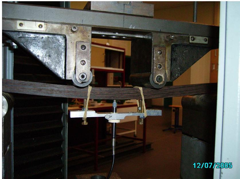
Figure 2.7: Configuration des essais de flexion statiques.
