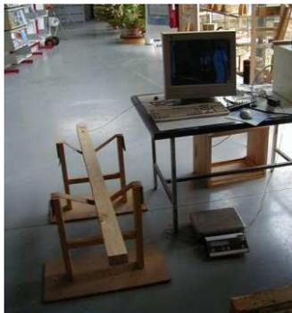
Figure 3.1 Matériel et appareil d'essai vibratoire: (la poutre est placée sur des supports élastiques, l'accéléromètre est fixé à une extrémité).
