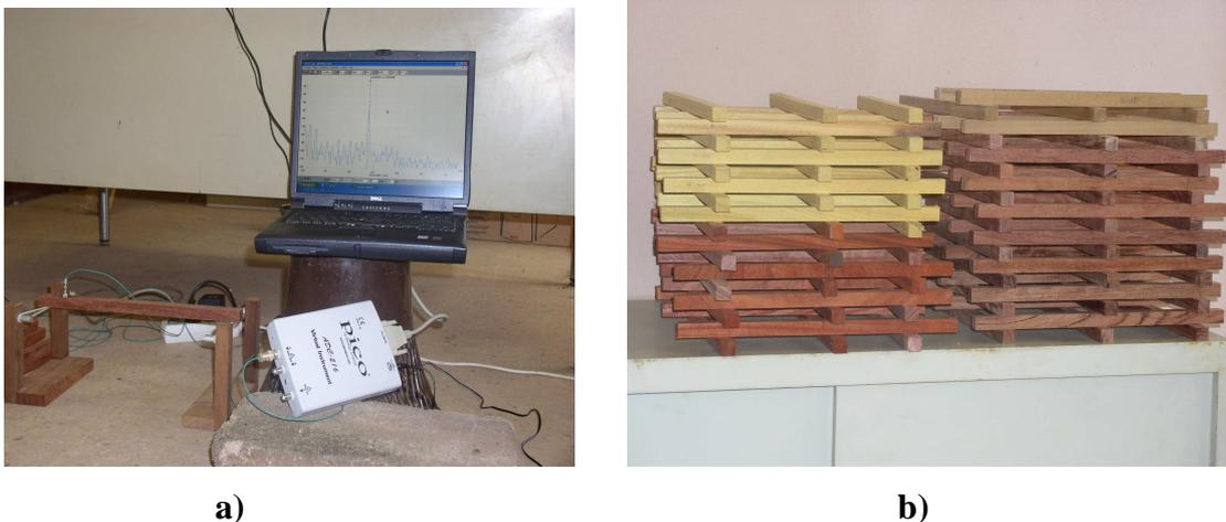
Figure 2.2: Matériel (a) et quelques éprouvettes (b) pour l'essai vibratoire.
