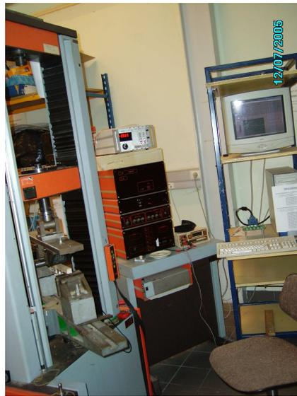
*Figure 2.9: Dispositif d'essai statique piloté par ordinateur.*
