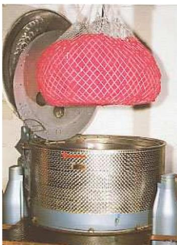
Figure A.1. Essoreuse centrifuge à déchargement par filet destinée aux textiles (document interne Robatel)
