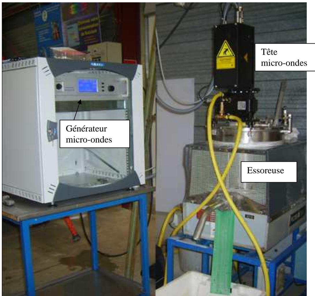
Figure 1 : Photo de l'ensemble du dispositifessoreuse-guide d'onde
