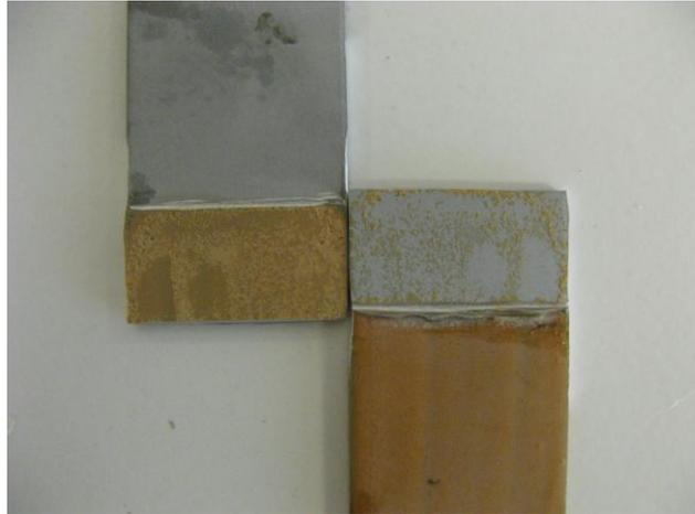
Figure 35 : Faciès de rupture du primaire 200 sur surface sablée
