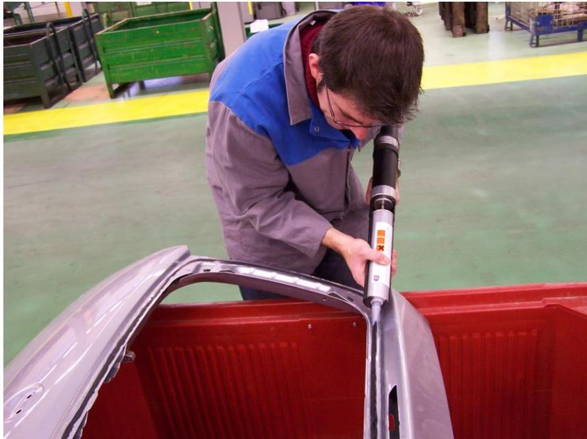
**Figure 78 : Dépose de l'adhésif démontable sur la carrosserie**
