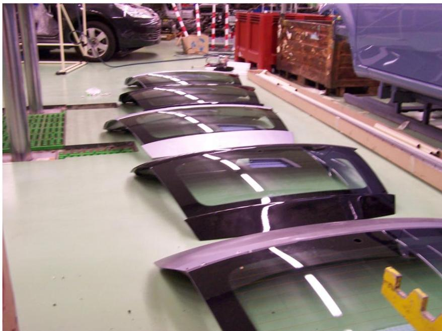
**Figure 79 : Vitrages collés avec le PUR démontable**
