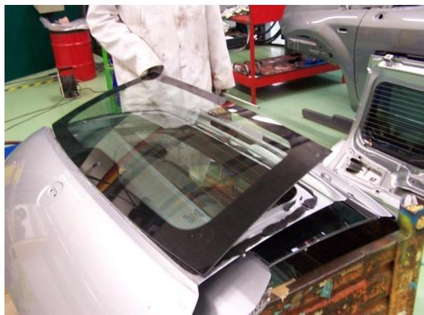
**Figure 82 : Activation quasi-complète du joint PUR**
