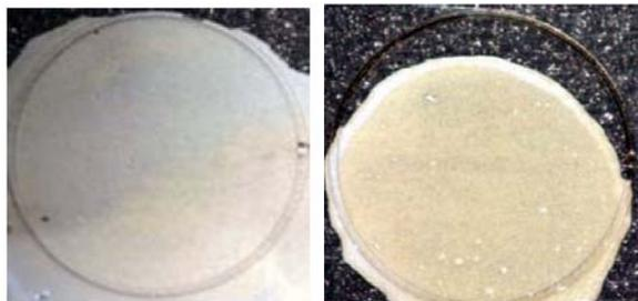
**Figure III.3. Aspect d'un dépôt effectué avec la méthode de la couche mince (à gauche), et avec la méthode sandwich (à droite).**
