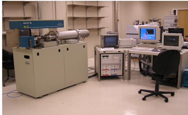
Figure III.7. Photographie du spectromètre de masse MALDI-TOF Bruker Reflex III
