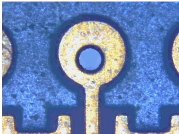
Figure 23 : Photographie d'un via à l'extrémité d'une ligne de test
