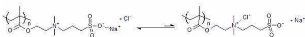
Schéma I-8 : Interactions des ions Na<sup>+</sup> et Cl<sup>-</sup> avec le PSPE
