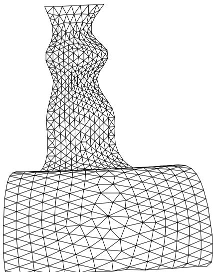
图 6.24(a)直接在参数域生成的曲面网格
