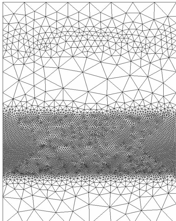
图 4.17(d) 梯度黎曼度量场构建后生成的网格
