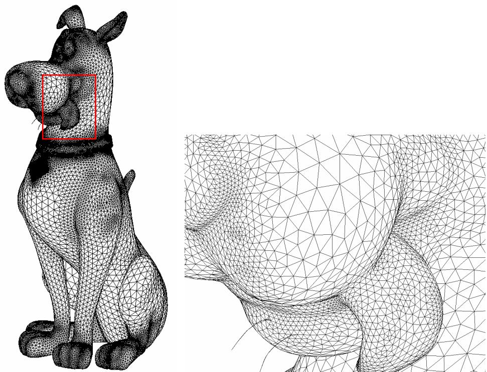
图 6.16 玩具狗及其局部放大的自适应剖分结果
