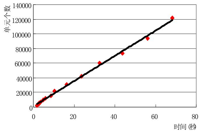
图 6.26 (b) 组合曲面的剖分单元个数和时间关系曲线
