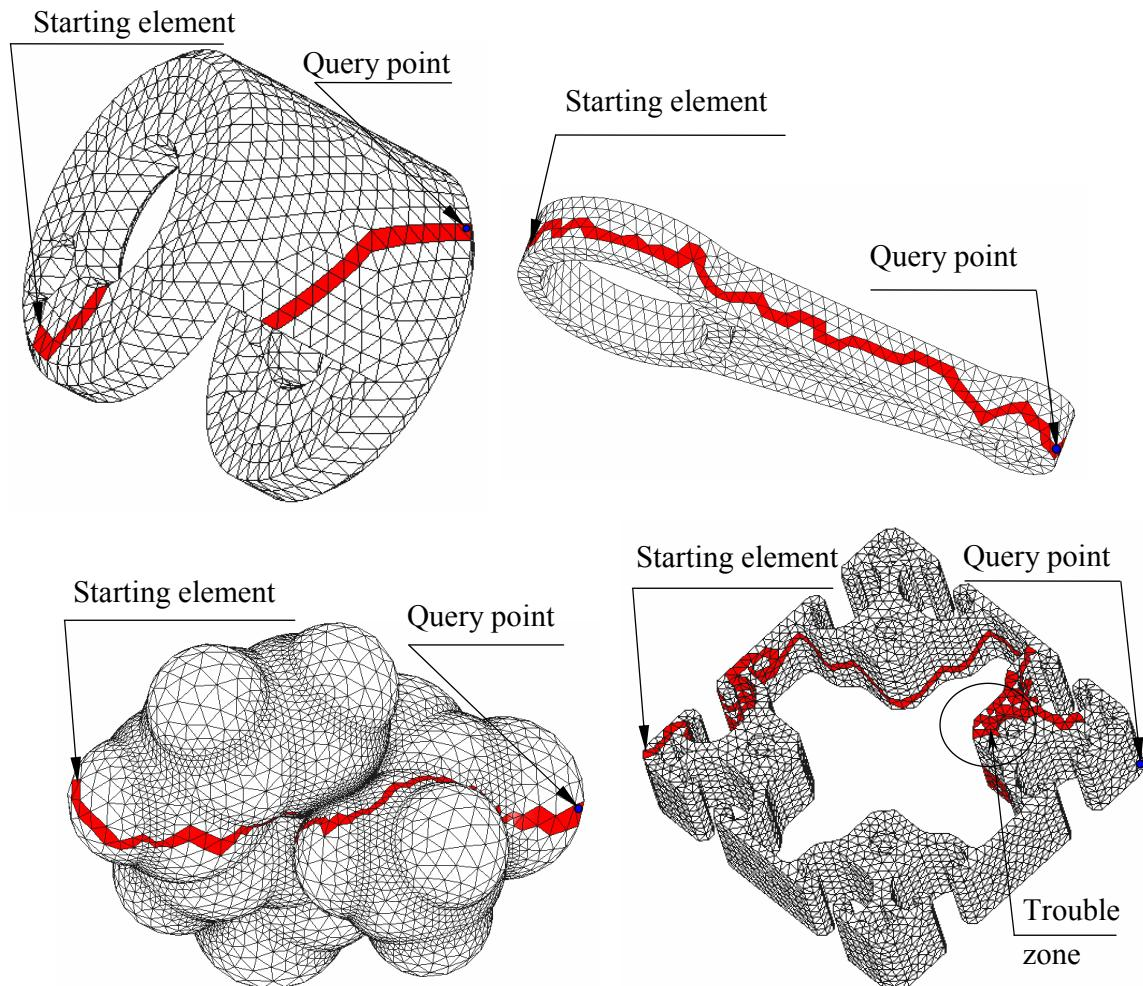
图 10.12 三维复杂域中点的定位
