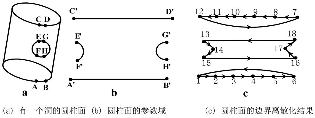
图 6.13. 有一个洞的圆柱面及其参数域的离散化结果
