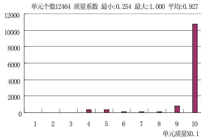
图 6.27(b)透平机叶轮的剖分结果的网格质量系数分布
