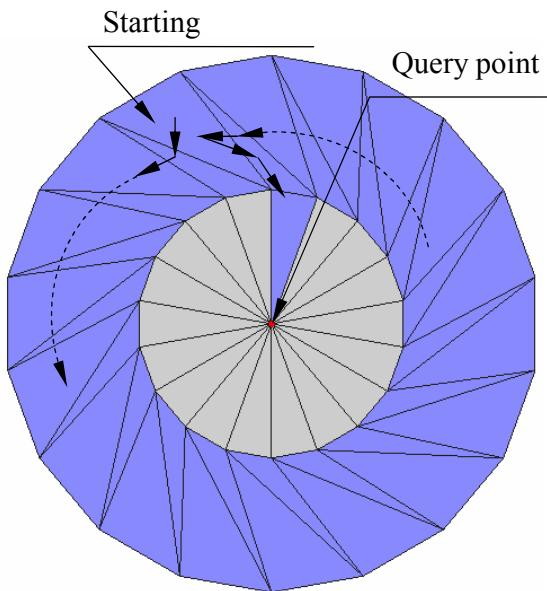
图 10.10 圆形域中点的定位
