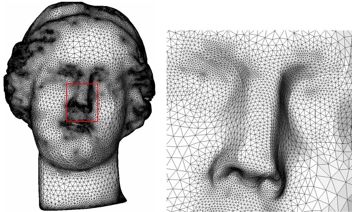
图 6.15 石膏头像及其局部放大的自适应剖分结果
