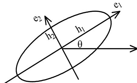
图 6.2 黎曼度量确定的控制椭圆
