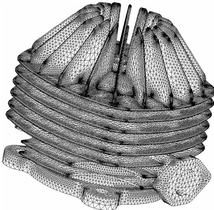
图 6.14 摩托引擎的自适应剖分结果
