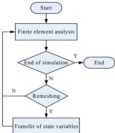
图 5.1 破坏模拟的一般过程
