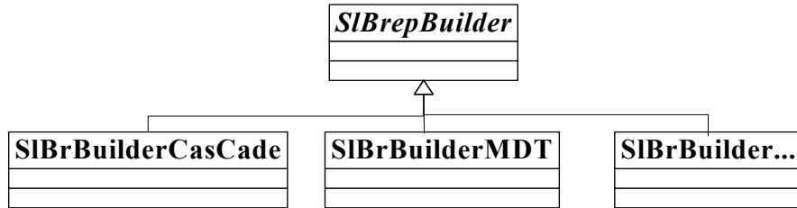
图 2.10 B-Rep 构造器的继承结构
