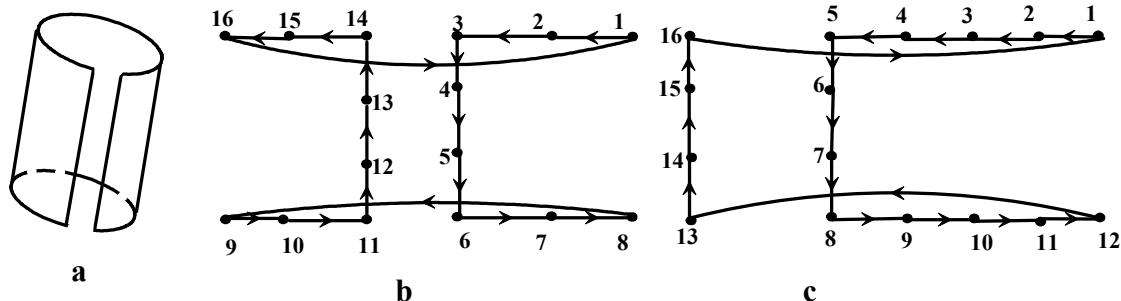
(a) 有一个槽的单周期曲面 (b) 离散化结果 1 (c) 离散化结果 2
