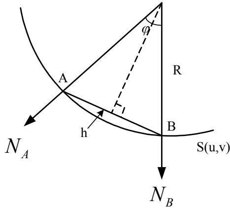
图 6.3 曲面上两点的曲率的近似求法
