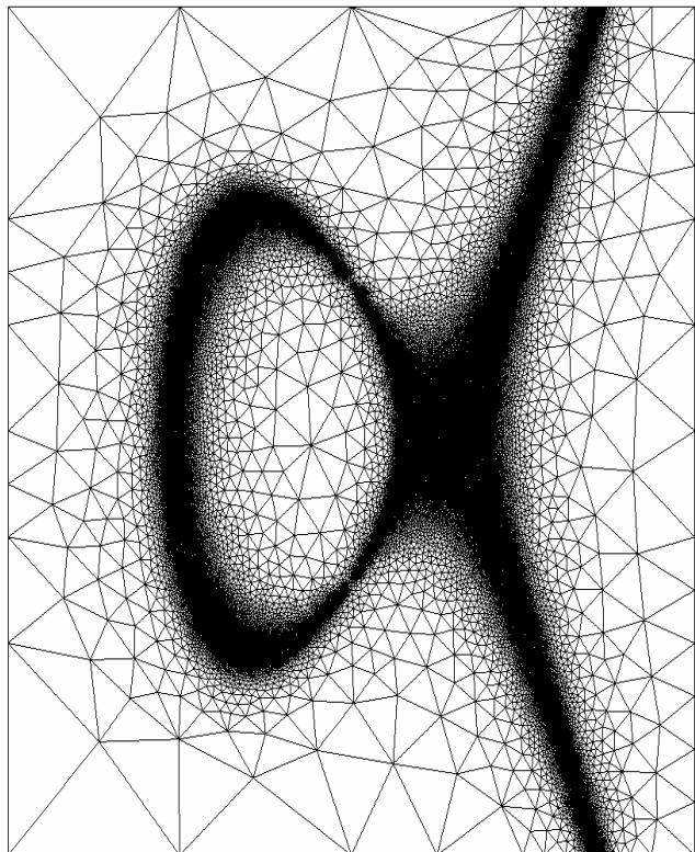
图 4.18 自适应算例 2
