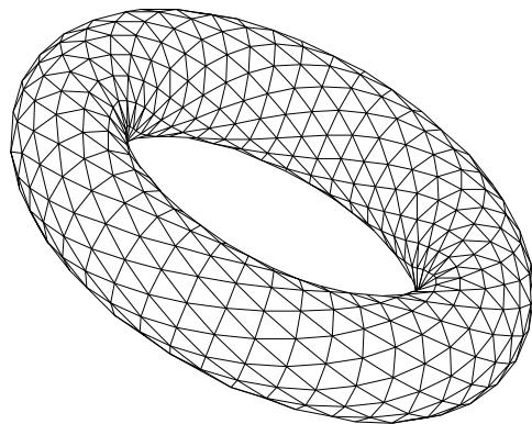
图 6.21c 本算法圆环面的剖分结果
