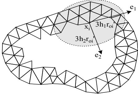
图 4.9 节点的参照高度  $h_{oi}$  和搜索半径  $r_{oi}$  的调整
