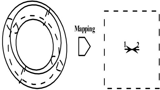
图 6.18 圆环面及其离散化结果
