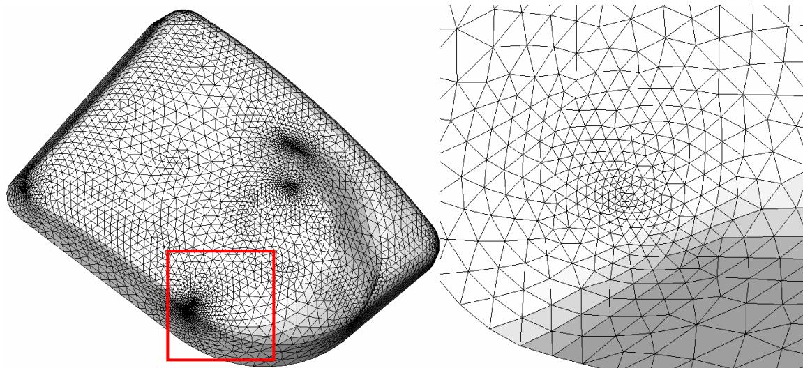
图 7.9 工件表面的自适应网格及局部放大图
