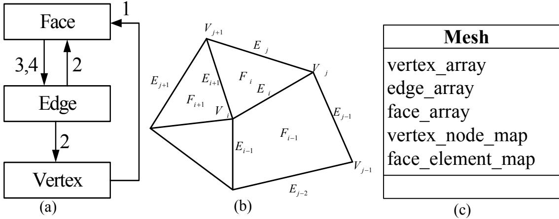
图 3.3 面网格数据结构的表示
