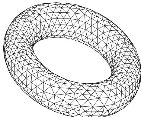
图 6.21d Ansys 圆环面的剖分结果
