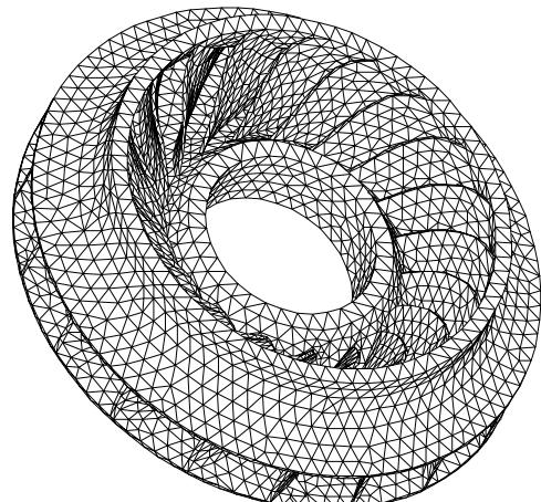
图 6.27(a) 透平机叶轮的剖分结果
