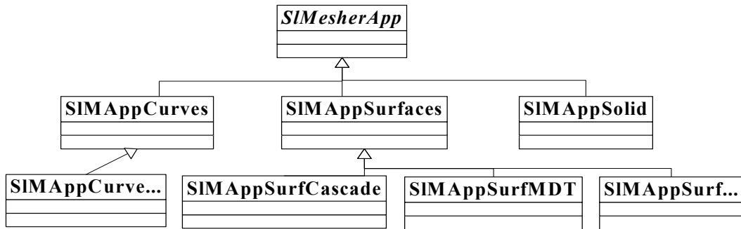
图 2.13 网格剖分应用程序继承关系图
