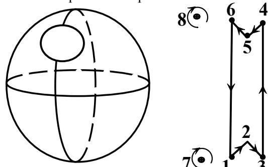
图 6.16 带孔洞圆球面及其离散化结果
