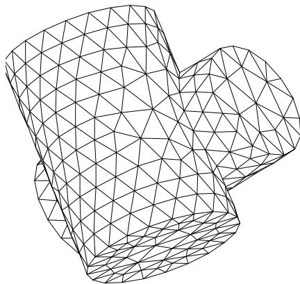
图 6.20c 整个模型的曲面剖分结果
