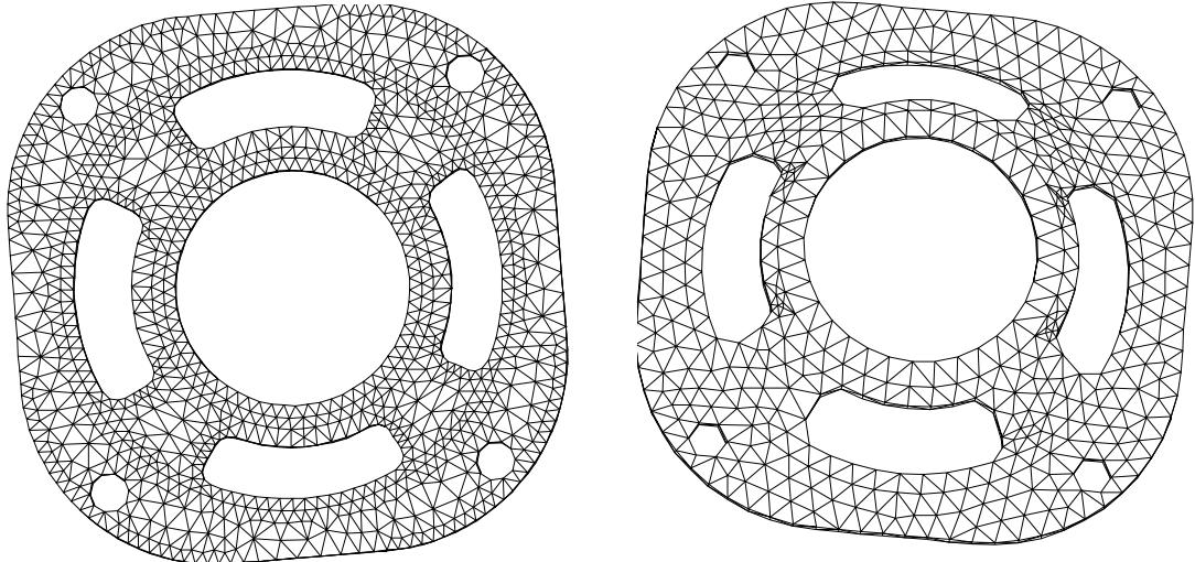
图 6.26(c) 组合曲面采用有限元软件 1 的剖分结果 图 6.26(d) 组合曲面采用有限元软件 2 的剖分结果
