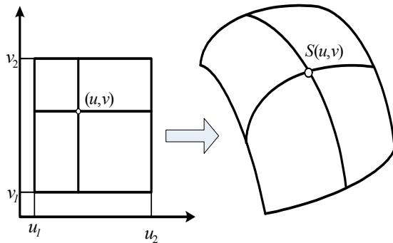
图 6.1 参数域上的点和曲面上的点的一一对应关系
