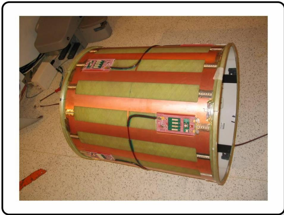
**Figure 18 Antenne corps de type cage d'oiseau (Birdcage)**
