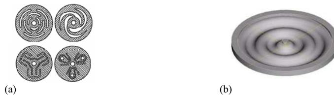
FIG. 3.23: *Représentations de membranes (a) planes découpées en « spiders » et (b) gaufrées.*
