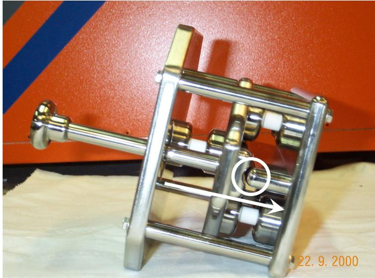
Figure 17 : Photo du déflecteur. Le cercle indique la zone de champ et la flèche donne la direction de l'axe  $z$
