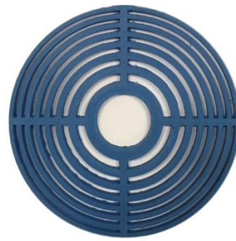
Figure 4 – Lentille acoustique en bioplastique PLA (acide polylactique), d'après (Tarrazó-Serrano et al., 2019).
