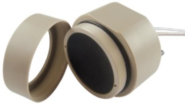
Figure 3 – Transducteur HIFU sphérique mono-élément (Imasonic – France).
