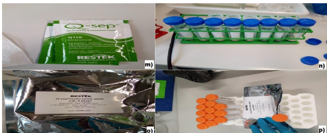
Figure 12: m) kits d'extraction QuEChERS ; n) Tubes centrifuges ; o) Les kits de purification QuEChERS ; p) Tubes centrifuges contenant les sels de purification
