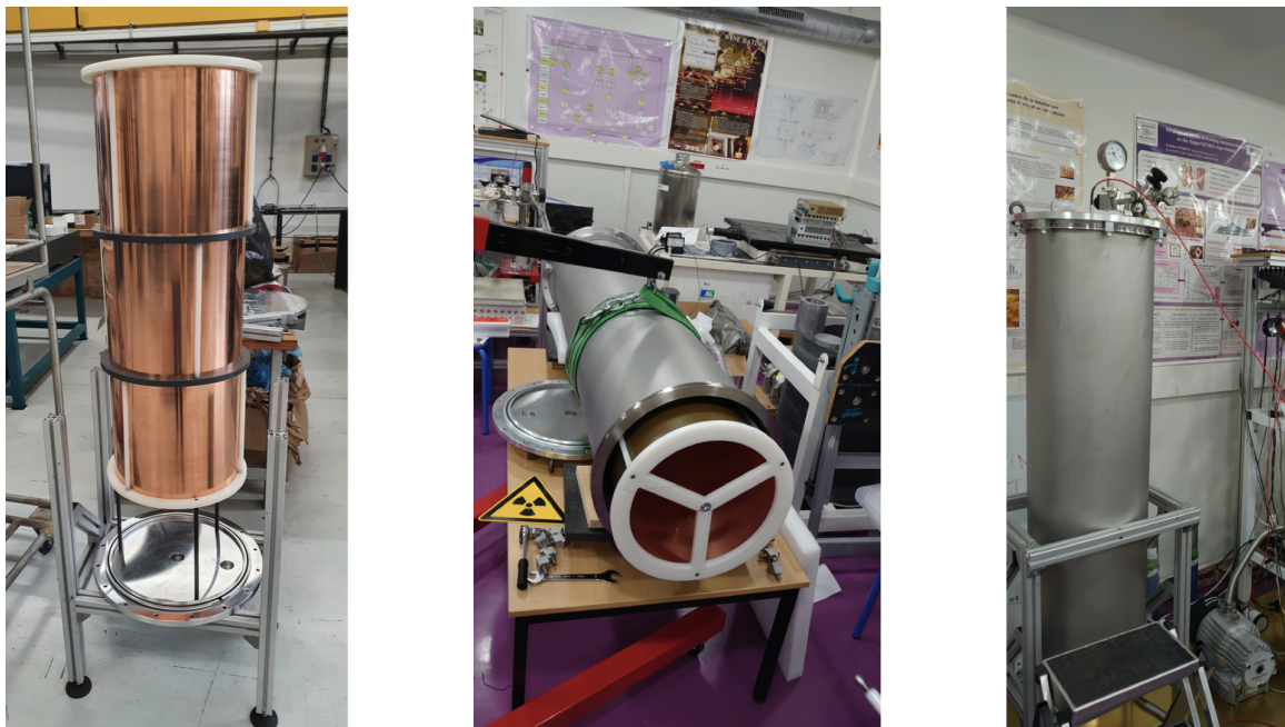
FIGURE 4.16 – Compteur Proportionnel Cylindrique. Gauche : la cathode positionnée sur le support de la CPC; Centre : Cathode placée à l'intérieur du réservoir en acier lors de l'installation au LP2i-Bordeaux; Droite : CPC installée et connectée aux systèmes de gestion du gaz et d'acquisition des données
