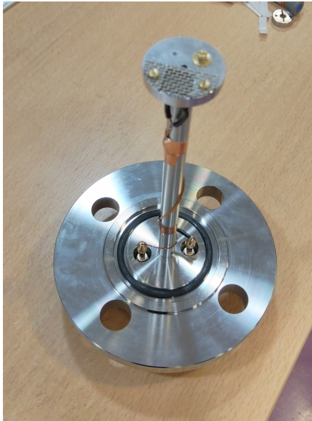
FIGURE 4.8 – Porte source monté sur la bride du second prototype. Le joint torique ainsi que les deux connecteurs BNC pour la tension et le signal du SiPM sont visibles sur la bride, un morceau d’adhésif cuivré maintient ensemble les câbles électriques et la tige du porte source. En haut de cette tige se trouve un disque au centre duquel est placé la source de ^{210}\text{Po} . Cette dernière est maintenue en place par pression mécanique à l’aide de la rondelle dorée décentrée. La grille qui protège la région de dérive du champ électrique du SiPM est maintenue par deux vis. Sous cette grille se trouve une cavité pour accueillir le SiPM.
