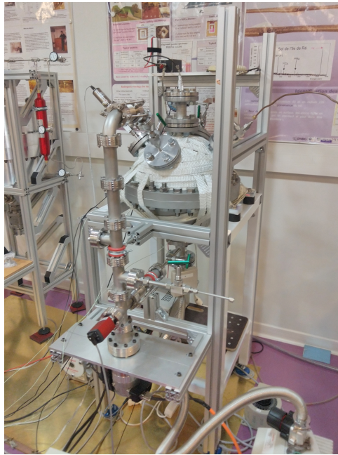
FIGURE 4.7 – Second prototype SPC certifié pour fonctionner à haute pression (40 bar). Son rayon interne est de 20 cm.
