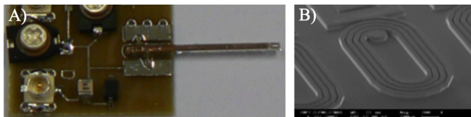
Figure 2.36. (A) Photographie du circuit électronique et de l'aiguille implantable. (B) Image obtenue par MEB de la micro-antenne planaire implantable [Baxan et al. (2007)].
