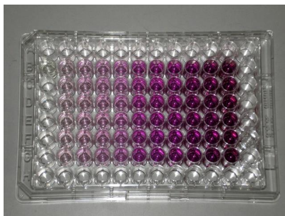
Figure 56. Exemple de plaque 96 puits ayant servi à réaliser un test de cytotoxicité au MTT-formazan. Les puits les plus violets contiennent le plus de cellules vivantes.
