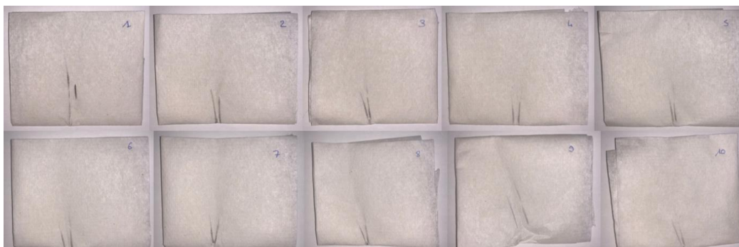
Figure A-9. Morceaux de papier imbibés d’acétone après plusieurs passages pour enlever la graisse à la surface du fil.
