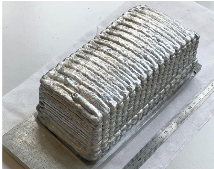
Figure II-70. Bloc de matière déposé avec succès ne présentant pas de porosités structurales.
