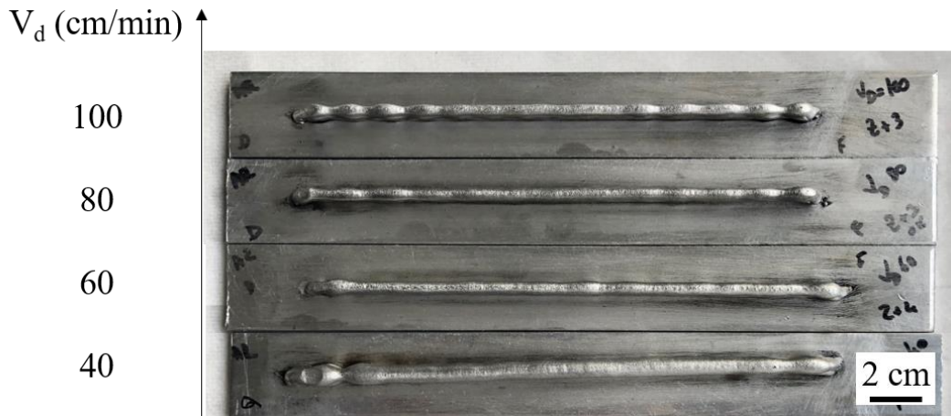
Figure II-32. Macrographies de la surface des dépôts composés de la superposition de 4 couches.
