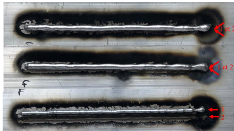
Figure II-62. Essais d'espacements permettant la juxtaposition de dépôts.
