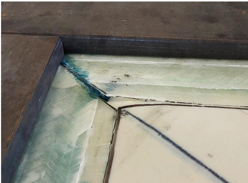
FIGURE 5.25. – Décalage entre deux liaisons flexibles lors de l'essai de la membrane carrée boulonnée et collée
