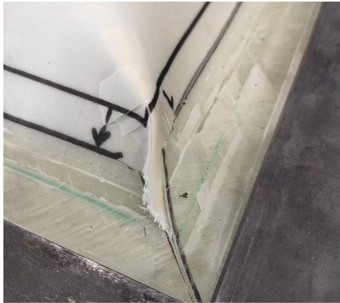
FIGURE 5.20. – Zone de rupture de la membrane carrée quasi-isotrope boulonnée après rupture
