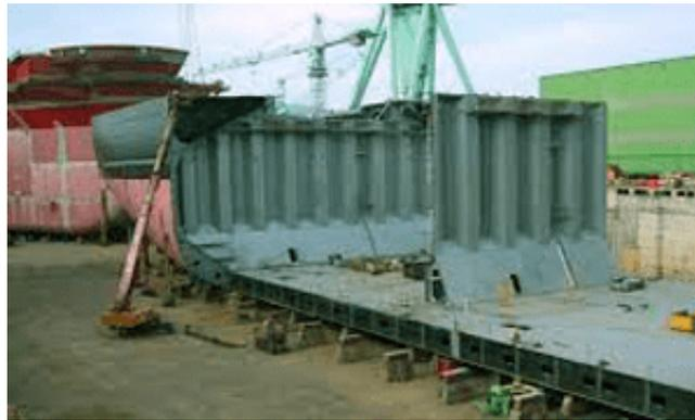
FIGURE 1.6. – Cloisons ondulées d’un cargo [19]
