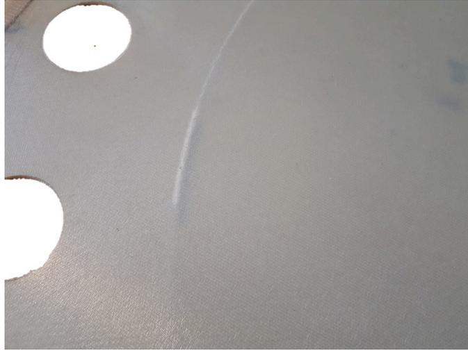
FIGURE 3.12. – Endommagement du bord de la membrane composite testée sans liaison flexible
