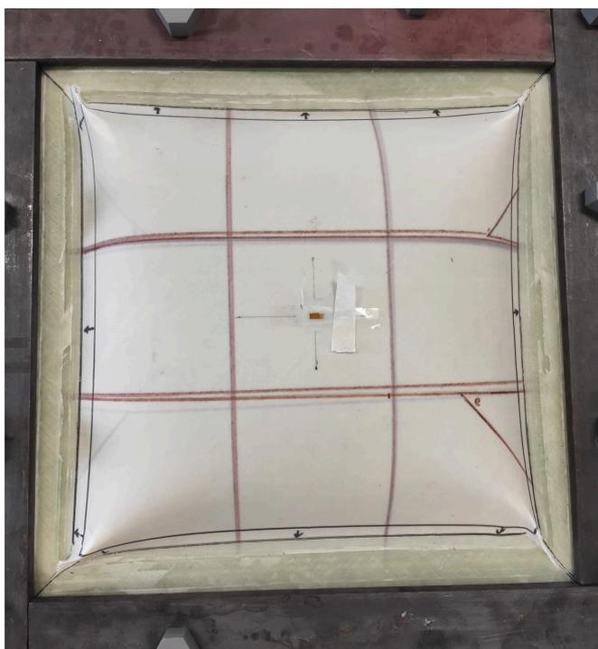
FIGURE 5.18. – Membrane carrée quasi-isotrope boulonnée après rupture
