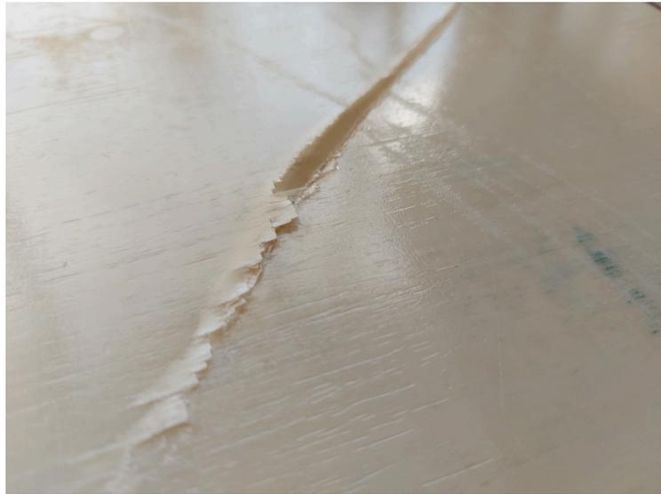
FIGURE 5.17. – Zone de rupture de la membrane carrée orthotrope boulonnée à la fin de l'essai
