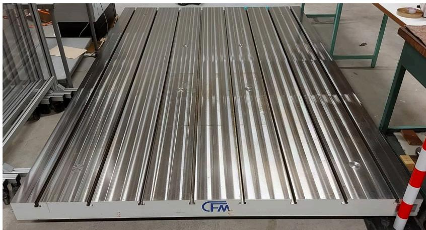
FIGURE 5.13. – Table rainurée utilisée pour le bridage du montage d'essai carré
