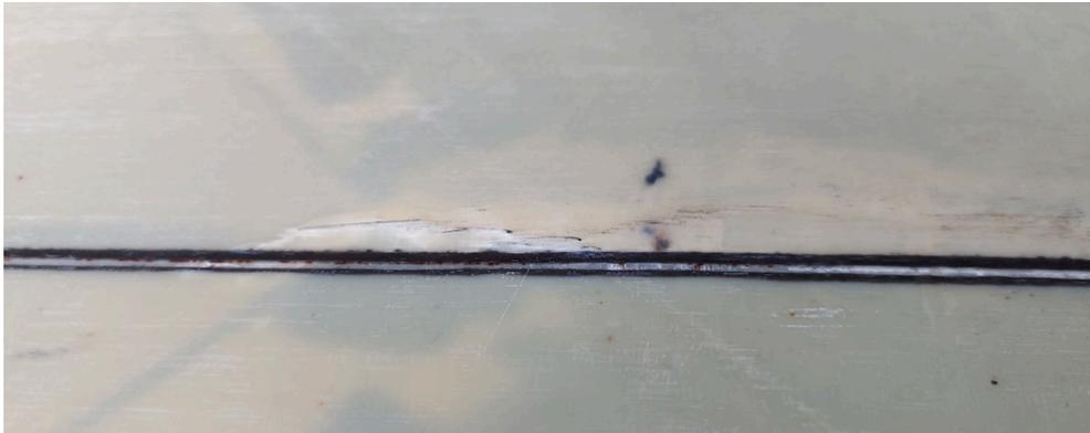
FIGURE 5.24. – Zone de rupture de la membrane carrée boulonnée et collée
