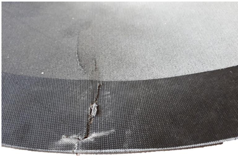
FIGURE 3.60. – Zone de rupture de la membrane orthotrope non-serrée
