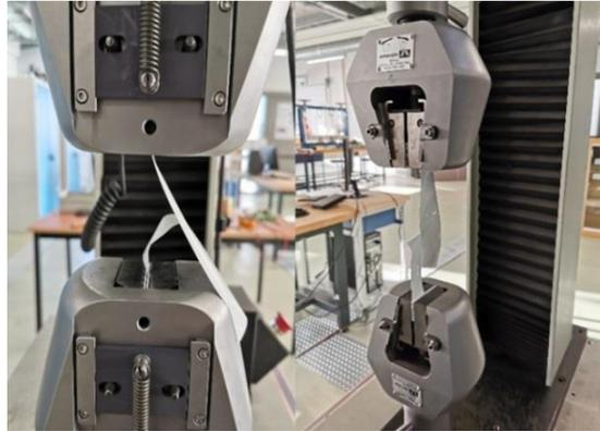
Figure 36 Montage de l'essai pantalon (Gauche: Avant essai/Droite: Pendant l'essai)
