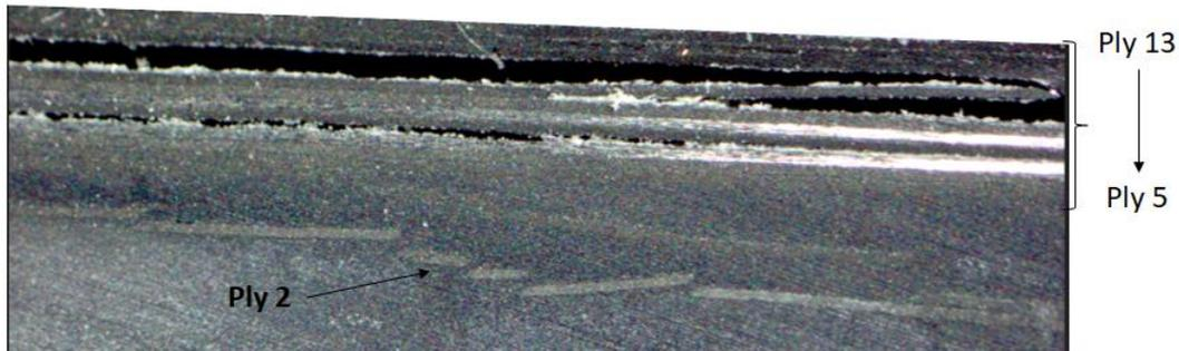
Figure 47 Endommagement interne pour une configuration sévère: CFRP (13plis) + ECF195 + 1000µm de peinture
