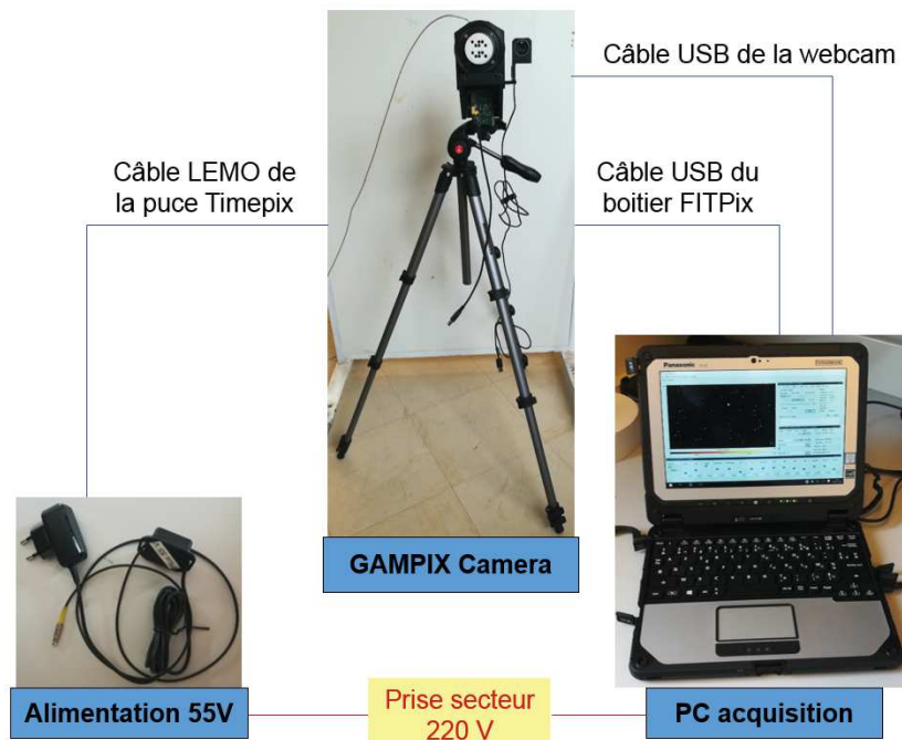
Figure 3.16 : Vue d'ensemble du système complet du prototype d'imageur neutronique sur un premier trépied.
