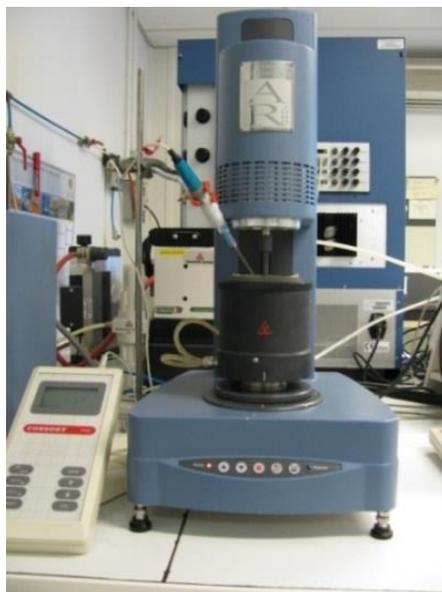
**Figure 23 :** Rhéomètre AR2000 équipé d'un système Couette et couplé à une électrode pH
