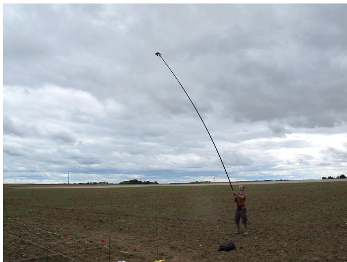
Figure 4. Acquisition d'images de la zone pour le MNS photogrammétrique.
