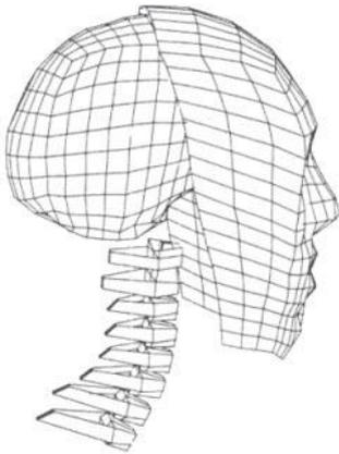
*Figure 22 : Modèle en éléments finis de la tête réalisé par Camacho [53]*
