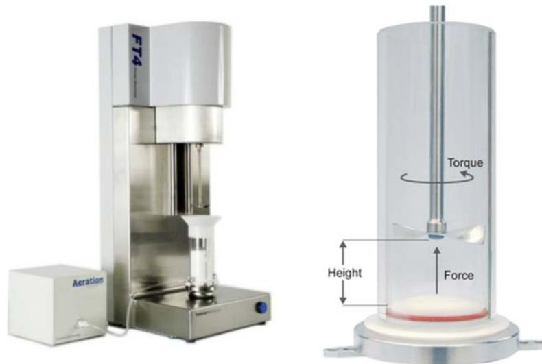
Figure II-5 : Principe du rhéomètre à poudres FT4.
