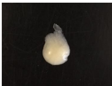
Figure 58 : CoPEC chitosan/alginate contenant des particules de carbonate de calcium, après ultracentrifugation.
