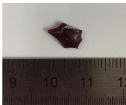
Figure 56 : Aspect du CoPEC \beta CD-chitosan/alginate-rhodamine après lavage et lyophilisation.
