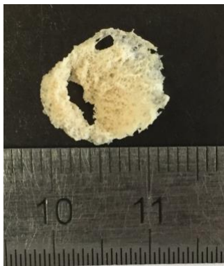
Figure 75 : Membrane de \beta CD-chitosan et d'alginate préparée par sédimentation et évaporation dans une plaque de 24 puits.
