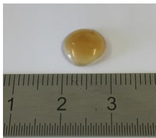
Figure 53 : CoPEC \beta CD-chitosan/alginate préparé par ultracentrifugation.
