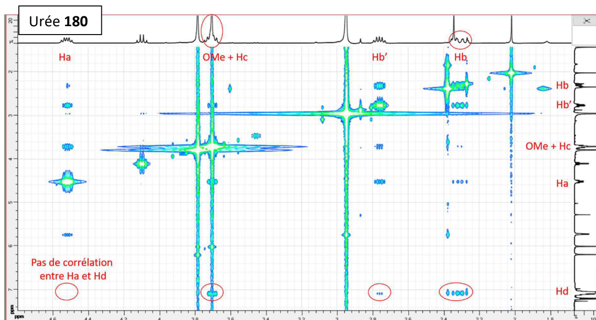
Figure 14. Résultats des NOESY de l'amine 150a et de son urée 180 . Les taches entourées en rouge dans les deux spectres ne montrent pas de corrélation entre Ha (proton en \alpha de l'azote) et Hd (protons du phényle), indiquant que Ha est en position trans avec le phényle et avec le OH en \alpha .
