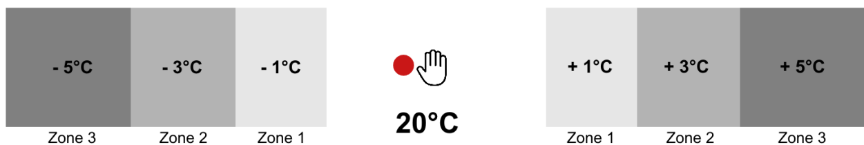
FIGURE 5.6 – Liens entre zone atteinte par l'objet virtuel et changement de température. Une représentation de la main et l'OV sont visibles au centre de la figure, au-dessus de l'affichage de la température. Les balayages de la main vers la gauche diminuent la température, alors que ceux vers la droite l'augmentent.
