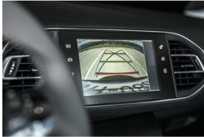
FIGURE 1.9 – La vue arrière du véhicule donnée sur l'écran central d'une Peugeot 308 de seconde génération.
