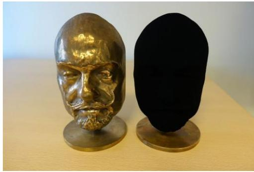
Figure 25 : Photographie de deux objets dont l'un est recouvert par un black absorber de type VANTA ; à gauche l'objet sans revêtement, à droite avec Vantablack [126].
