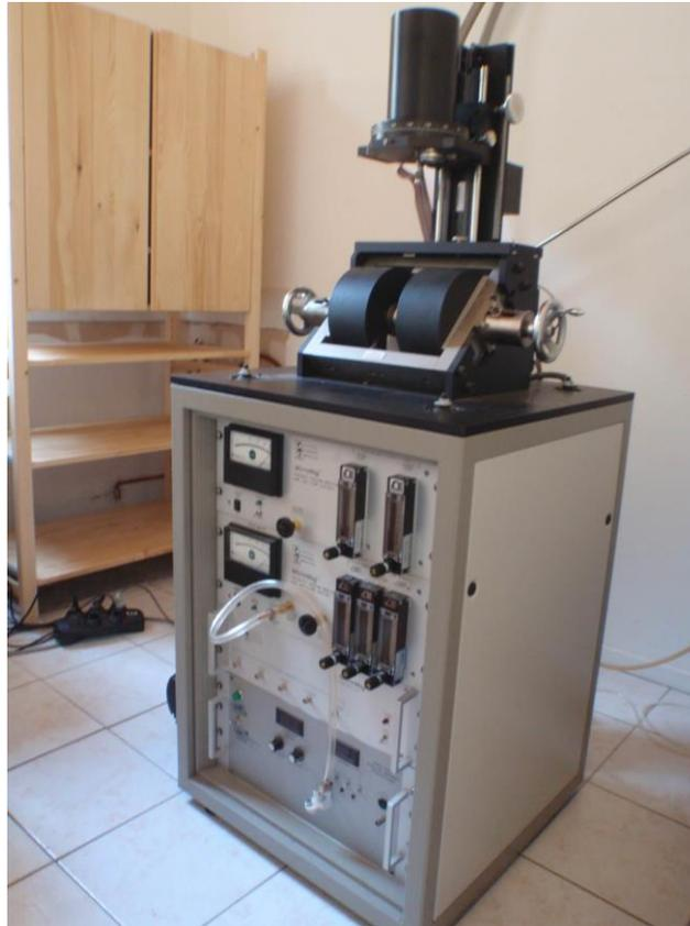
Figure 35: Photo du magnétomètre à échantillon vibrant Micromag 3900 utilisé au CEREGE pour les mesures d'hystérésis de nos échantillons.
