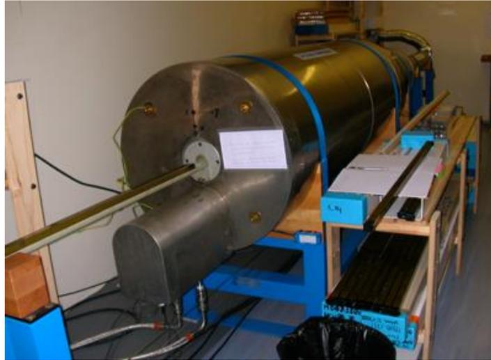
Figure 31: Le magnétomètre cryogénique SQUIDs utilisé au laboratoire de magnétisme du CEREGE. Les échantillons sont placés sur la rampe visible à gauche, qui est ensuite insérée dans l'appareil de mesure.
