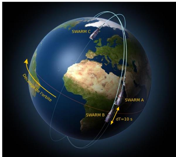
Figure 6: Schéma de déploiement de la constellation des satellites Swarm autour du globe. L'orbite du satellite C'est au début parallèle aux deux autres, mais se décale au cours du temps pour devenir à terme perpendiculaire. <http://www.ipgp.fr/en/geomag/geomagnetism>.
