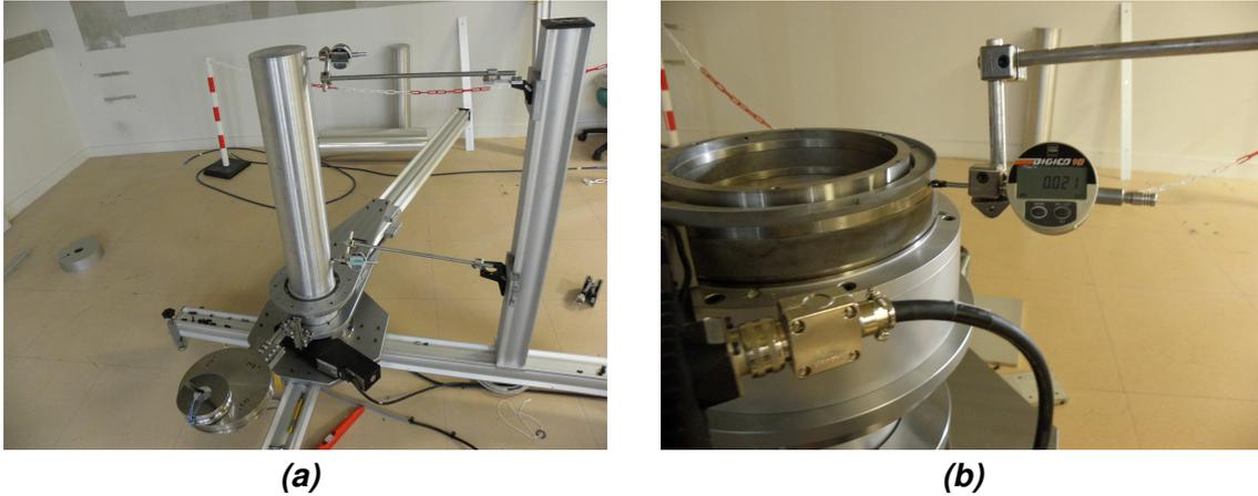
**FIGURE 3.12.** – Photos du montage expérimental avec **a)** le test du positionnement du cylindre et **b)** le positionnement du moteur support.
