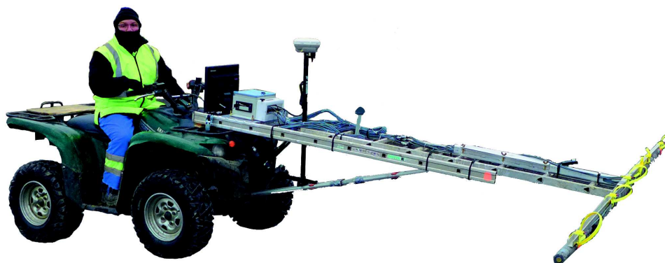
FIGURE 4.12 – Dispositif d'acquisition monté sur un quad.
