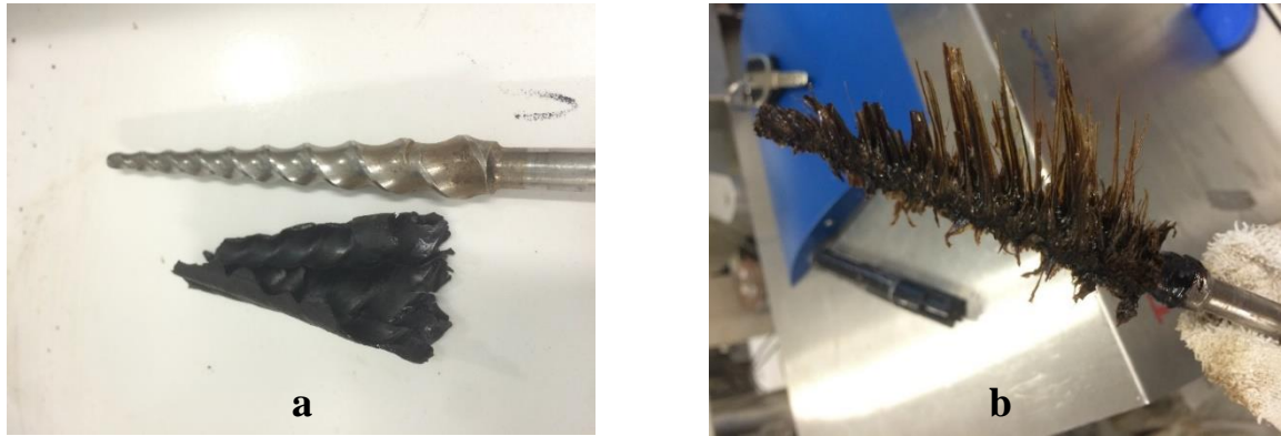
Figure 83 Extrusion de deux lignines plastifiées avec 20% DMSO + 20% eau: OL (a) et KLS (b)
