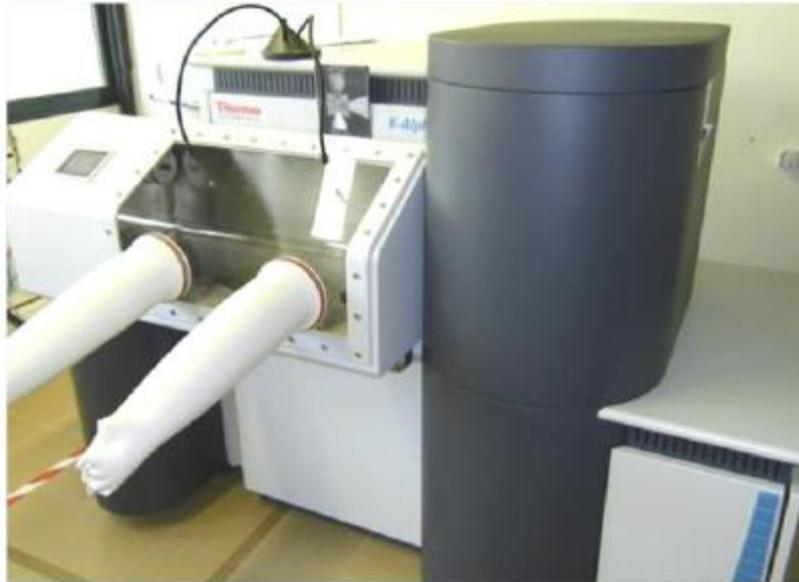
Figure 92 : spectromètre XPS K-alpha de Thermo-Fisher avec sa boîte à gants connectée
