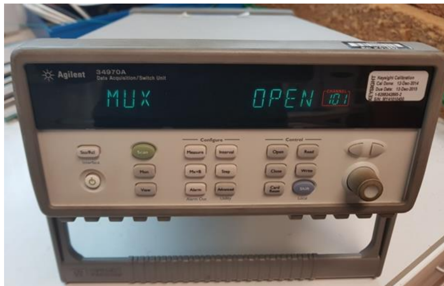
Figure 5.11. – La centrale d'acquisition : AGILENT-34970A
