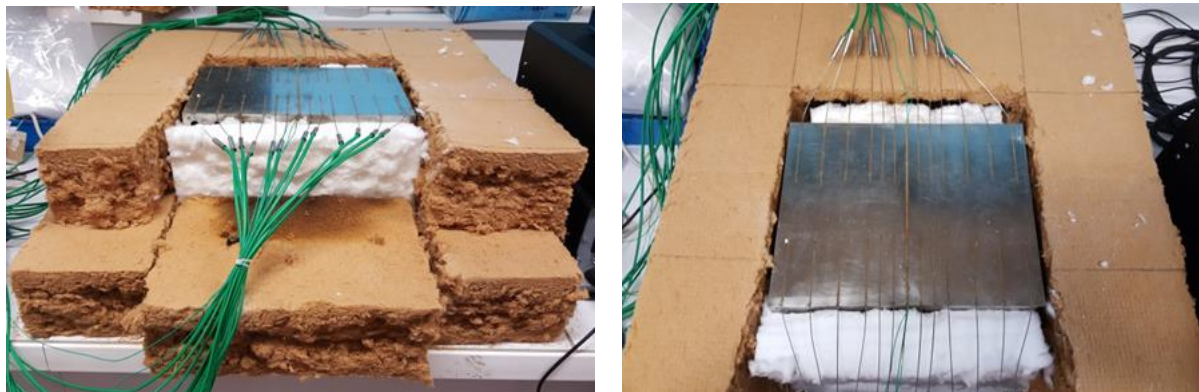
Figure 5.7. – Disposition de l’isolant autour du bloc en acier
