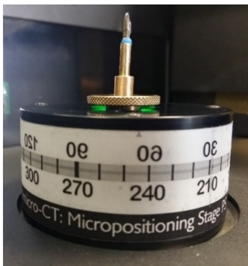
Figure 3- 15 : Montage utilisé pour fixer les micro-prélèvements lors des acquisitions de microtomographie.
