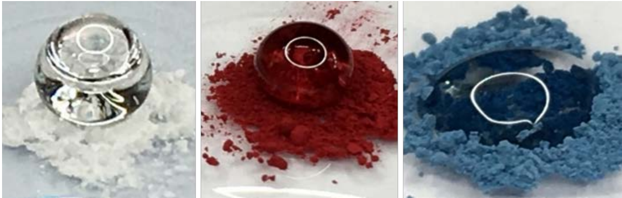
Figure 6- 9 : Photographies à la loupe binoculaire mettant en évidence la haute tension de surface du solvant eutectique chlorure de choline:glycérol (1:2) avec du blanc de plomb, de l'hématite et de l'azurite.
