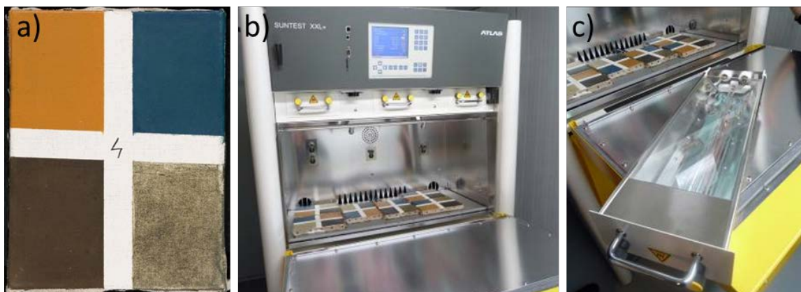
Figure 3- 1 : a) Epreuve © C2RMF/Jean-Louis Bellec ; b) Enceinte Atlas SUNTEST XXL+ ; c) Lampe arc Xénon
