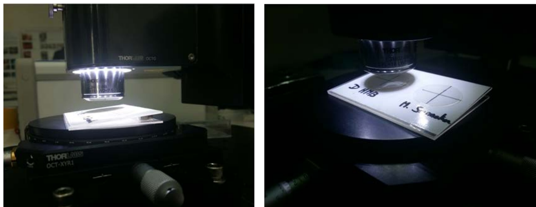
Figure 3- 8 : Montage pour les analyses de vernis par OCT
