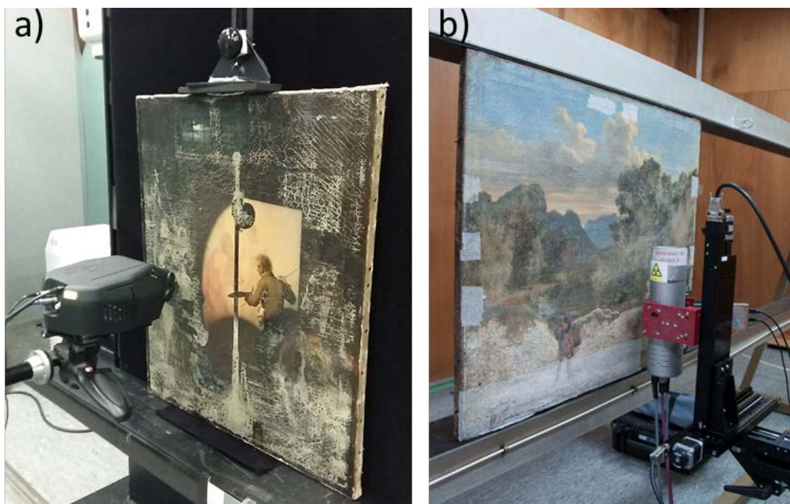
Figure 3-7 : a) Système de fluorescence X portable ponctuel. Analyse de l'œuvre de François-Louis Dejuinne, Girodet peignant "Pygmalion et Galatée" dans son atelier ; b) Système de cartographie 2D. Analyse de l'œuvre de Anne Louis Girodet-Trioson et/ou Jean-Pierre Pequignot, Chasseur dans un paysage .
