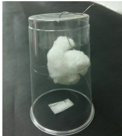
Figure 6- 5 : Dispositif pour la régénération d'échantillons modèles par des vapeurs de solvants
