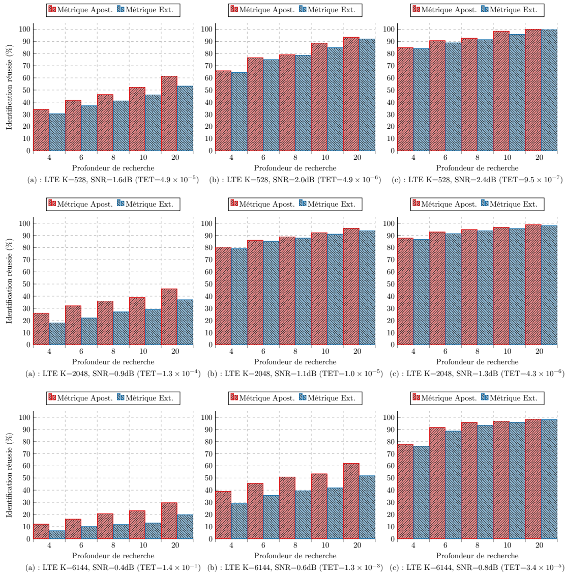
FIGURE 3.5 – Pourcentage d'identification réussie des erreurs résiduelles pour différents turbo codes du standard LTE K=528, K=2048 et K=6144 avec R=1/3. Décodage EML-MAP itérant 8 fois.
