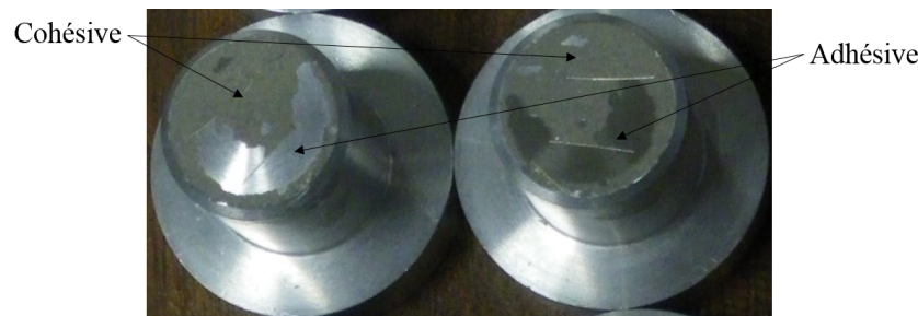
FIGURE 3.2 – Exemple d'une rupture mixte avec la 3M 2216 pour une éprouvette sans primaire d'accrochage
