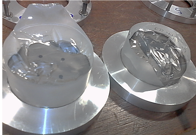
FIGURE 4.9 – Rupture adhésive de l'adhérence moléculaire du verre de silice suite au traitement intermédiaire pour une sollicitation de choc en cisaillement
