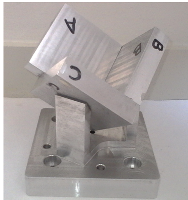
FIGURE 5.6 – Le coin de cube en aluminium collé sur son DFM en aluminium
