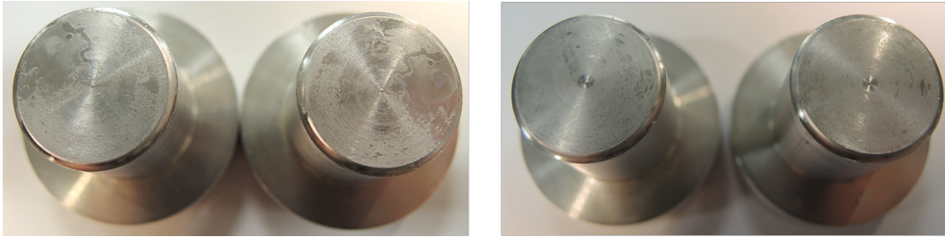
FIGURE 3.26 – Exemple de faciès de rupture pour la Cyanoacrylate
