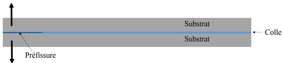
FIGURE 1.17 – Principe de l'essai DCB
