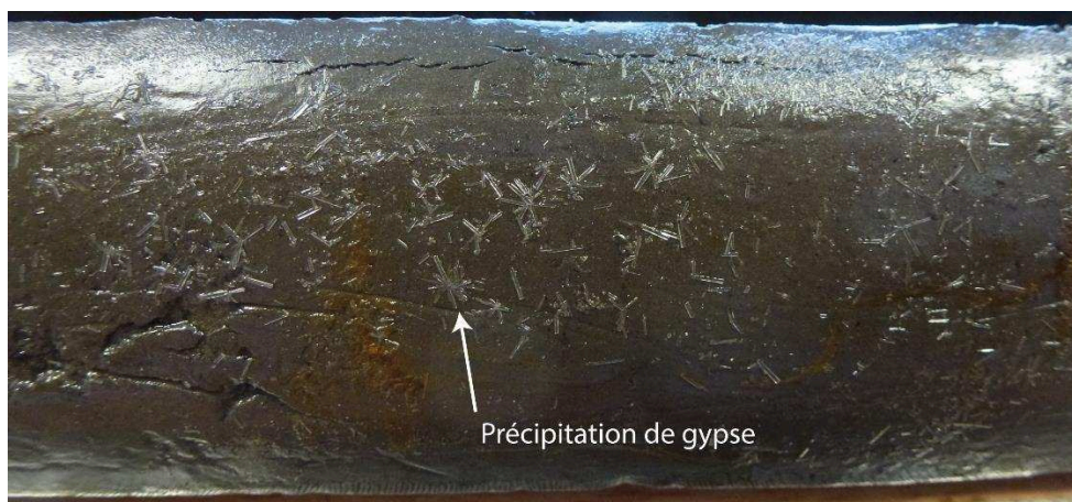
Figure 23 : Exemple de formation de gypse à la surface des carottes sédimentaires du marais de Cannuta.
