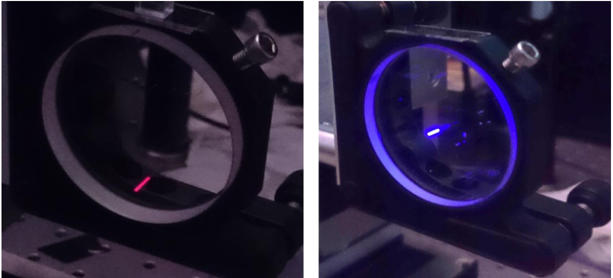
Figure 55 : A gauche : Tube de photoluminescence volumique rouge observé dans un échantillon de UV fused silica traversé par le faisceau laser à 266 nm. A droite : Tube de photoluminescence volumique bleu observé dans un échantillon d’Infrasil épais traversé par le faisceau laser à 266 nm. Dans les deux cas, le site irradié n’est pas endommagé.
