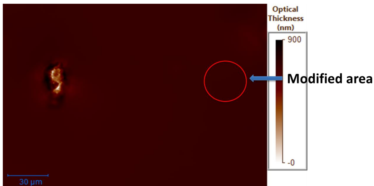
Figure 101 : Image d'un début de ligne de modifications avec un endommagement (sur la gauche) et une zone modifiée (sur la droite). Dans cet exemple, l'espacement inter-sites est de 150 μm et non 300 μm.
