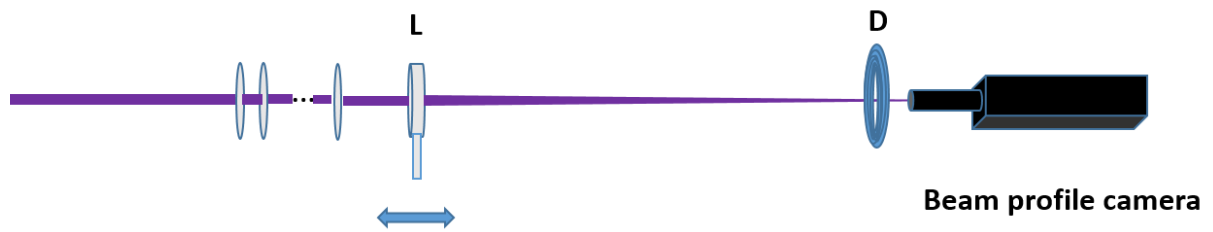
Figure 21 : Principe d'acquisition du profil spatial du faisceau laser. L = lentille, D = diaphragme.
