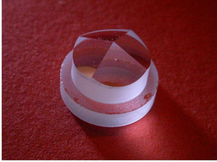
Figure 7.5 – Photographie d'une pyramide transparente et description dans le formalisme des pavages. m_{\Delta} est la fonction de transparence du masque Pyramide. \alpha code l'angle de son sommet.
