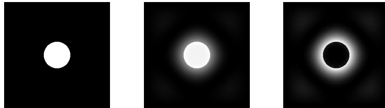
Figure 8.4 – Intensité constante pour trois configurations de masques de Zernike. r assure l' équipartition de l'énergie dans les trois cas et \delta vaut de gauche à droite 0, \lambda/4 et \lambda/2 . On note l'extinction sur le support de la pupille dans la dernière configuration.
