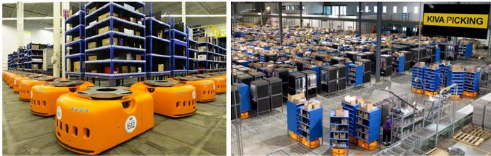
FIGURE 1 – Les AGVs Kiva [Wurman et al., 2008], utilisés dans les entrepôts de l’entreprise Amazon
