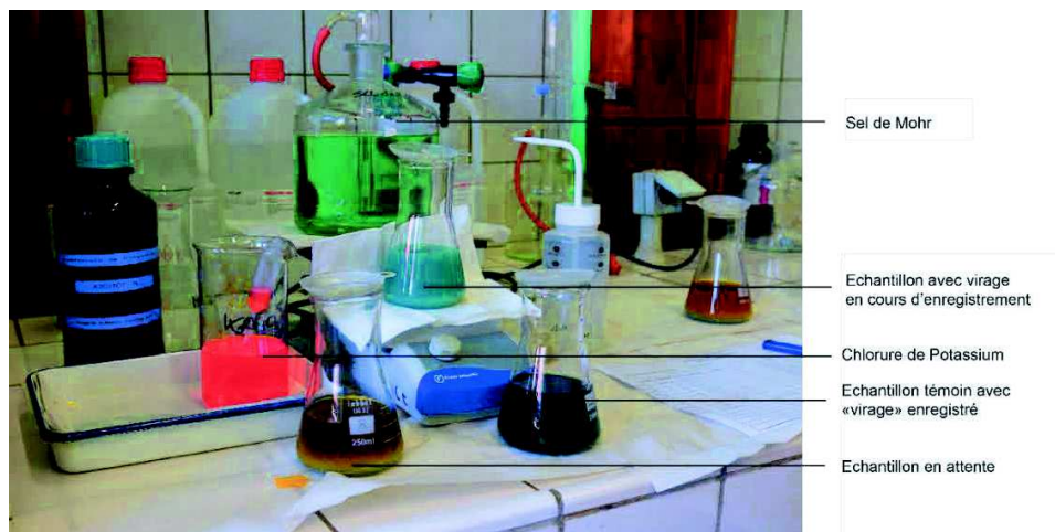
Figure 4.11 : Manipulation de Walkley et Black pour la mesure du Carbone organique ; Source Photo : Dominique Schwartz
