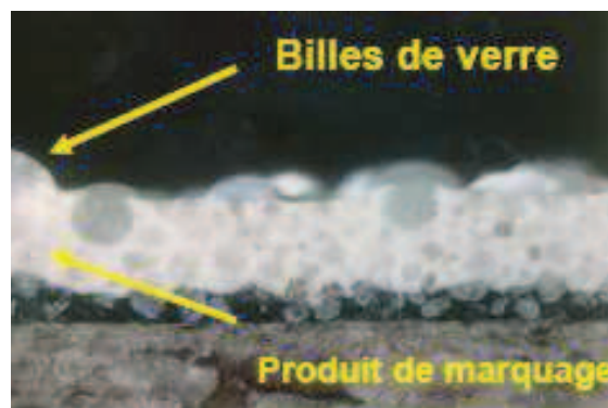
Photo d'une coupe, prise dans le sens vertical, d'un marquage routier avec billes de verre
