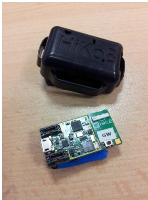
FIGURE 3.2 – Système Hikob Fox comprenant une carte électronique, sa batterie et son boîtier
