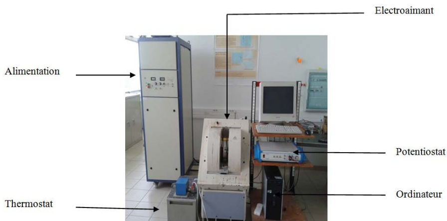
FIGURE 2.1 – Photographie du dispositif expérimental avec champ magnétique.
