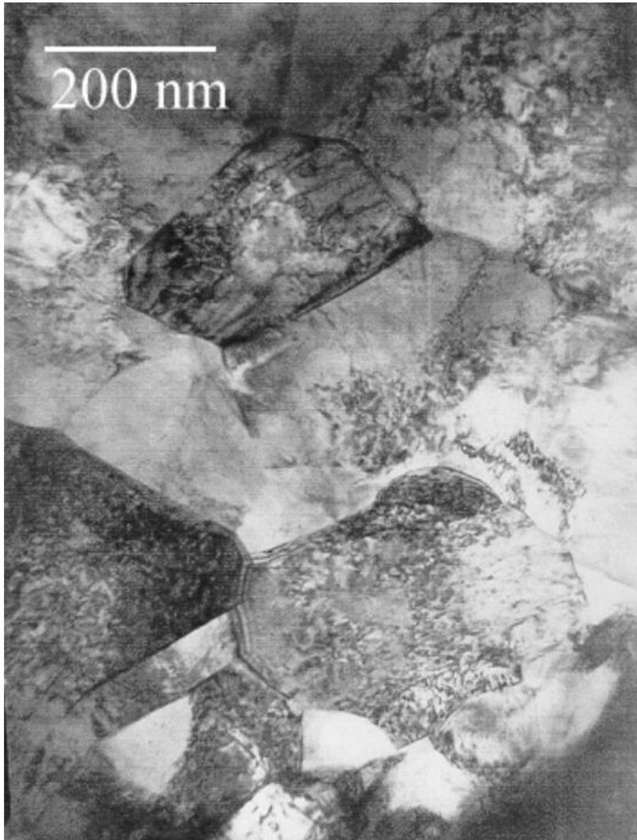
Figure 1. 21 : vue transverse d'une zone de cuivre large, dans un canal Cu-2 ou Cu-3 [40].
