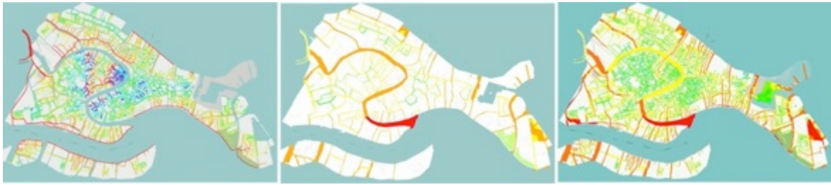
图 2.2 威尼斯道路网络及水路网络的结构中心度(Structurality)分析 (©Perna)
